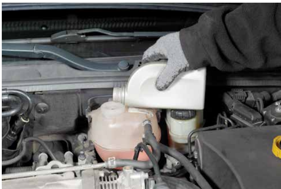
Figura 2 – Reposição do líquido de arrefecimento
