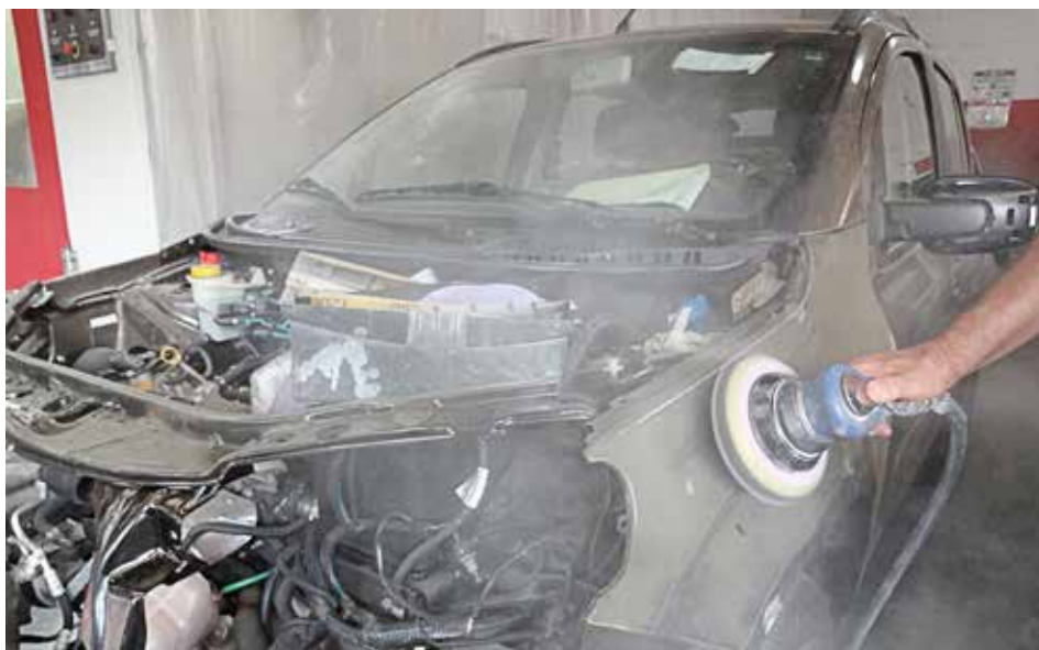
Figura 14 – Emissão de particulados na etapa de lixamento
