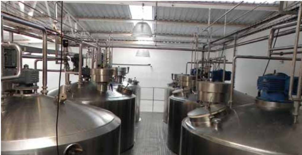
Figura 12 – Fermentadores de logurte. | Fonte: Autores, 2014
