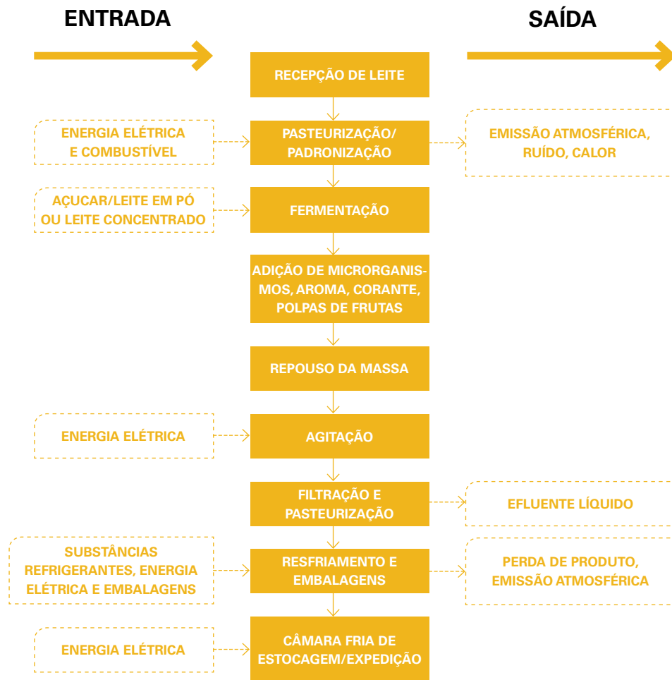
Figura 13 – Fluxograma da fabricação de iogurtes | Fonte: Autores, 2014
